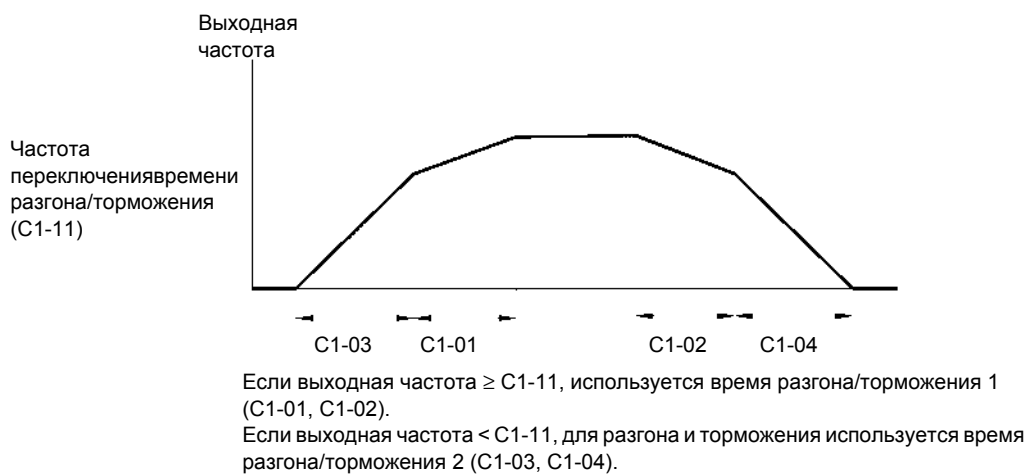
Рис. 6.18 Переключение времени разгона/торможения по частоте
