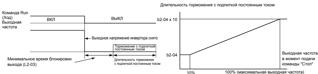
Рис. 6.16 Торможение с подпиткой постоянным током
