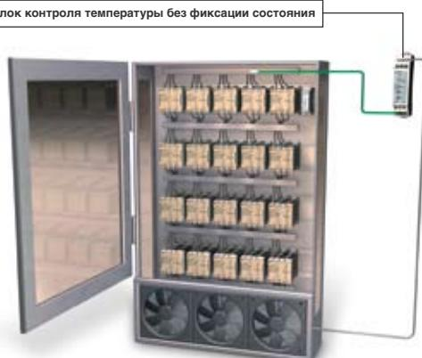
Вследствие рассеивания тепла от твердотельных реле температура в электрошасси может возрасти до уровня, при котором невозможна их эффективная работа. Простой модуль управления в режиме ВКЛ/ВЫКЛ на базе реле K8AB-TH позволит защитить шкаф от перегрева, исключая необходимость применения постоянно работающих вентиляторов.
